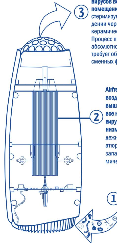
Очищенный воздух без вирусов возвращается в помещение. Воздух стерилизуется при прохождении через узкие каналы керамического ядра. Процесс протекает абсолютно бесшумно, не требует обслуживания и сменных фильтров.
